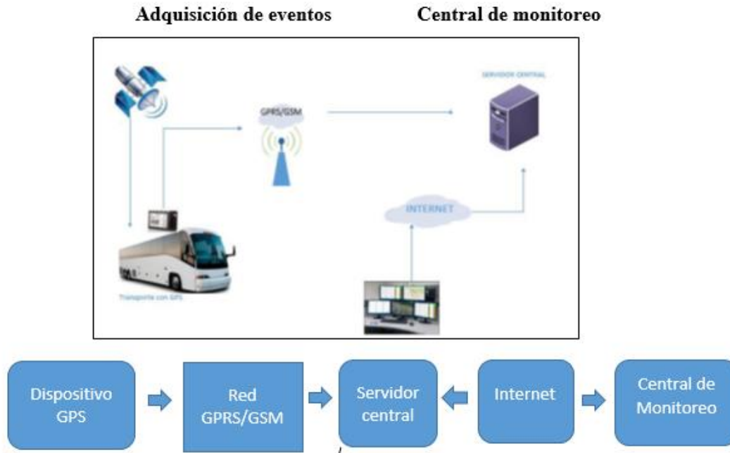
Figura 2. Arquitectura del sistema y diagrama de bloque del sistema Fuente: (Astudillo, 2018)
